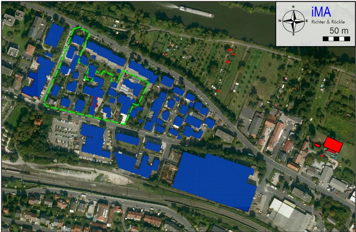
Abbildung A2-1: Lage der im Modell berücksichtigten Geruchs-Emissionsquellen (rot) und Gebäude (blau). Die Lage des Bebauungsplangebiets ist grün dargestellt. Luftbildgrundlage: onmaps.de © GeoBasis-DE/BKG 2023 © Hexagon.
