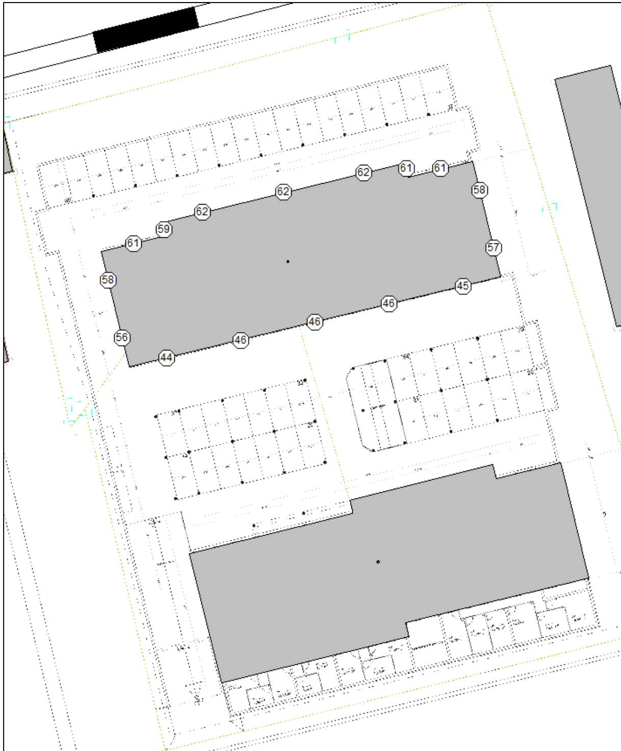
Bild 11: Gebäudelärmkarte 3. Obergeschoss, Schienenverkehrslärm nachts in dB(A)
