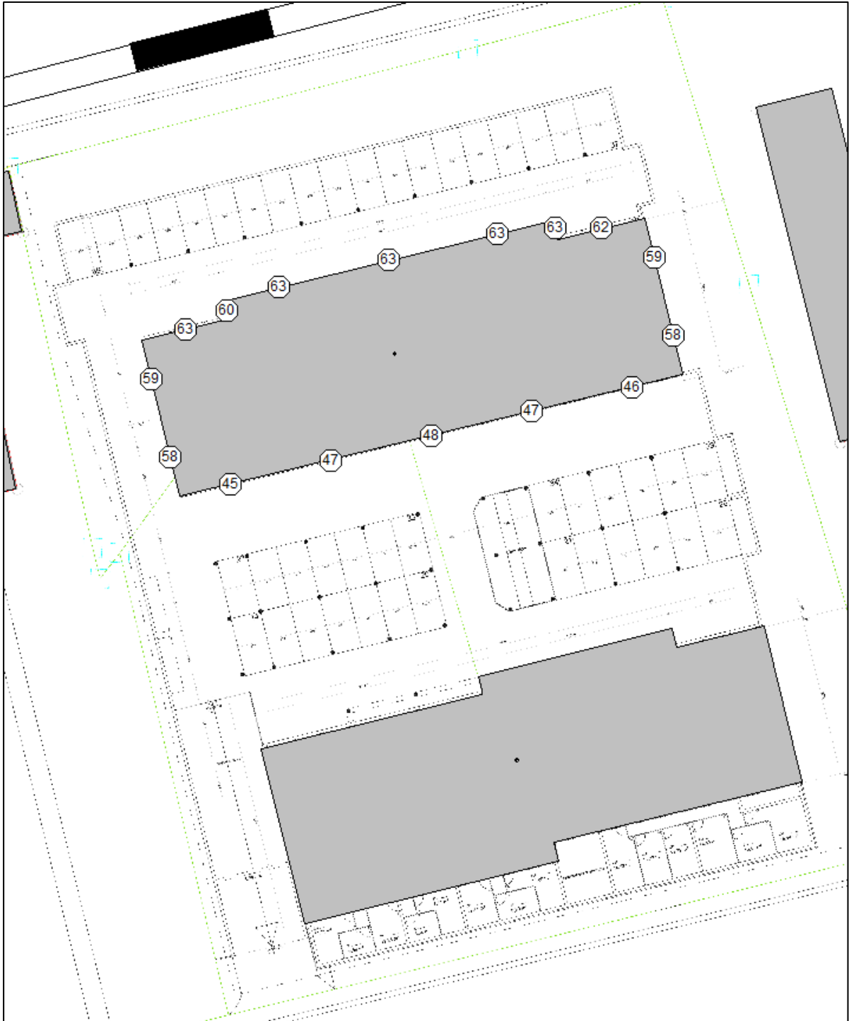
Bild 10: Gebäudelärmkarte 3. Obergeschoss, Schienenverkehrslärm tags in dB(A)
