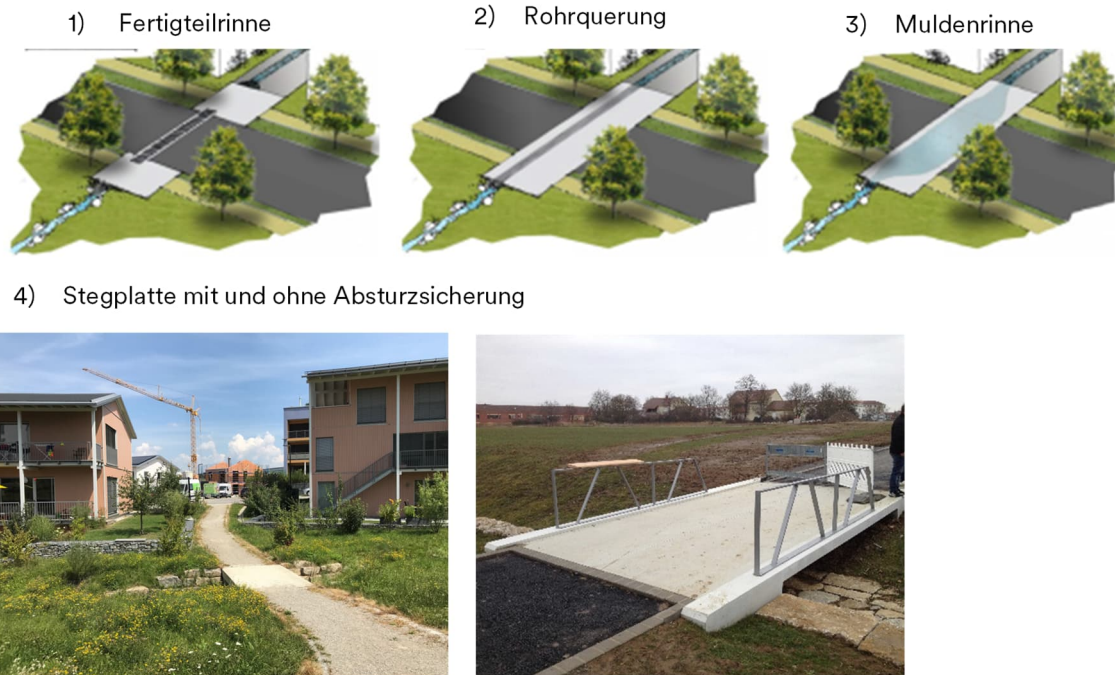
Abbildung 33: Vier Typologien für Straßen und Wegequerungen (Grafik, EQP Pfaffenhofen, Unicampus Würzburg, HL)
