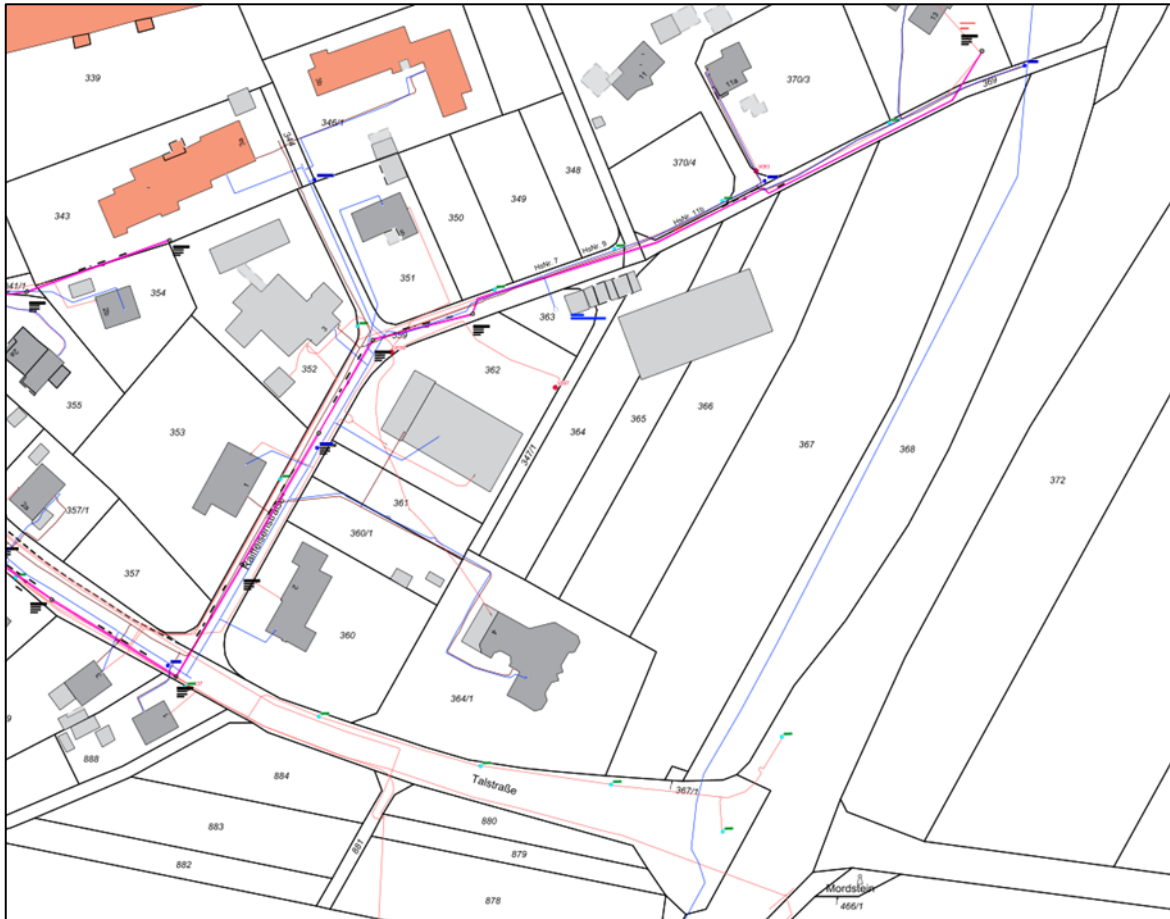
Abbildung 3: Ver- und Entsorgung des Gewerbegebietes, Geltungsbereich 1. Änderung des Bebauungsplanes "Gewerbegebiet Sylbach, Teil 2" (Grundlage: Bayerische Vermessungsverwaltung - www.geodaten.bayern.de ; Eigene Bearbeitung)
