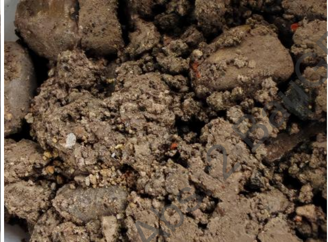
Foto 20: Homogenbereich 1.4 – kiesige Auffüllung, unbelastet, mit Fremdbeimengungen (hier: Probe BS009-BP9.2)
