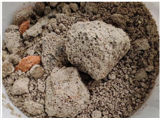
Foto 18: Homogenbereich 1.4 – Bauschutt-Auffüllung (Ytong, Ziegelbruch), gering belastet (hier: Probe BS010-BP10.2)
