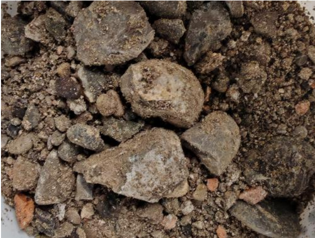
Foto 13: Homogenbereich 1.2 – kiesige Auffüllung, gering bis mittel belastet, mit Fremdbeimengungen (hier: Probe BS010-BP10.3)
