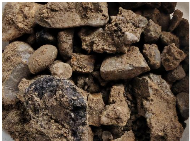
Foto 12: Homogenbereich 1.2 – kiesige Auffüllung, gering bis mittel belastet, mit Fremdbeimengungen/mit Asphalt (hier: Probe BS008-BP8.1)
