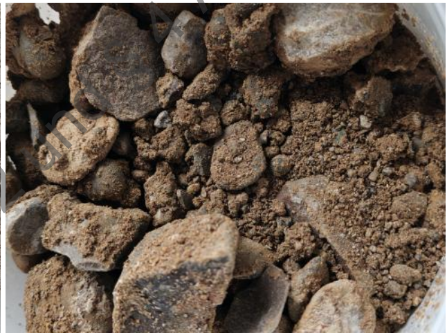
Foto 10: Homogenbereich 1.1 – kiesige Auffüllung, unbelastet, ohne Fremdbeimengungen (hier: Probe BS001-BP1.1)
