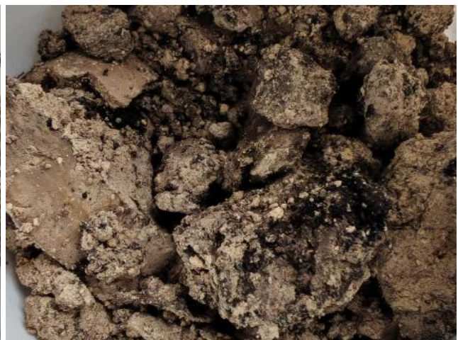
Foto 24: Homogenbereich 2.2 – Wiesenalkal, torfig, unbelastet (hier: Probe BS008-BP8.3)
