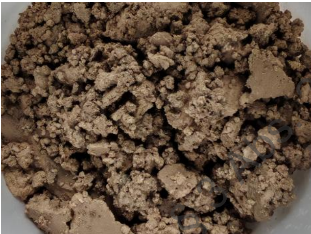
Foto 21: Homogenbereich 2.1 – Wiesenalkal, belastet (hier: Probe BS004-BP4.5)
