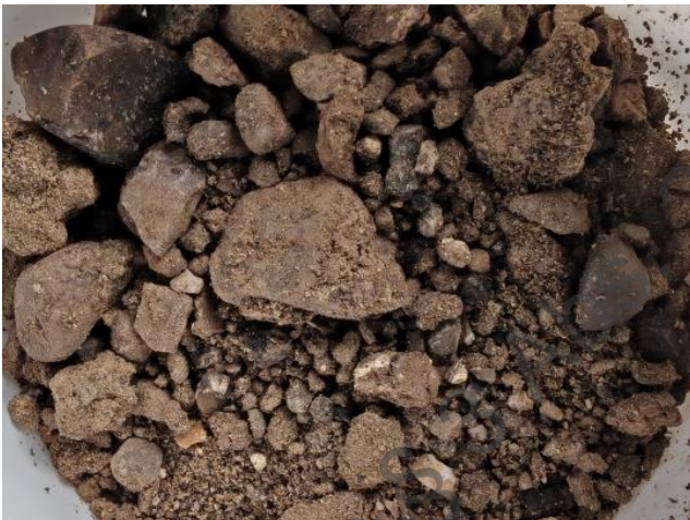
Foto 15: Homogenbereich 1.3 – kiesige Auffüllung, hoch belastet (hier: Probe BS008-BP8.2)
