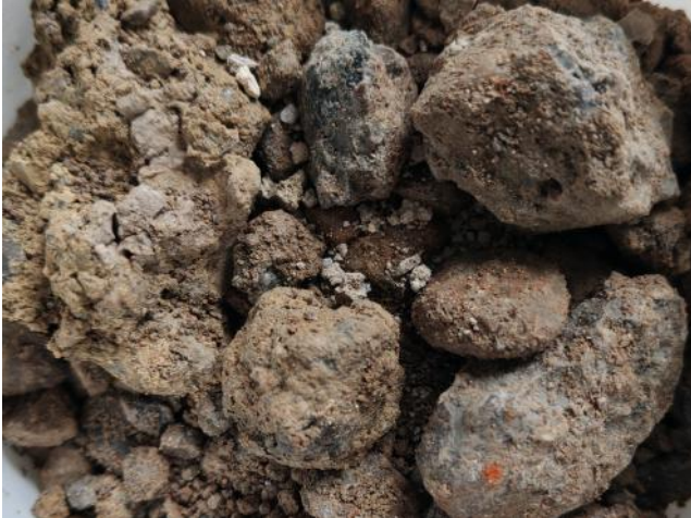
Foto 19: Homogenbereich 1.4 – kiesige Auffüllung, unbelastet, mit Betonbruch (hier: Probe BS001-BP1.3)
