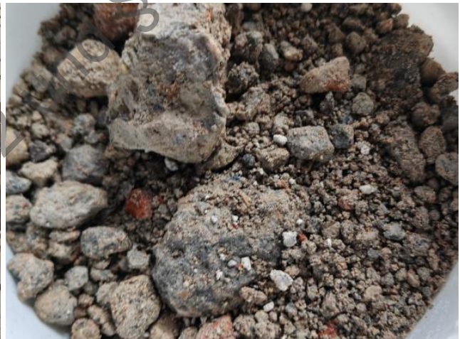
Foto 16: Homogenbereich 1.4 – Bauschutt-Auffüllung (RC-Beton), gering belastet (hier: Probe BS002-BP2.3)
