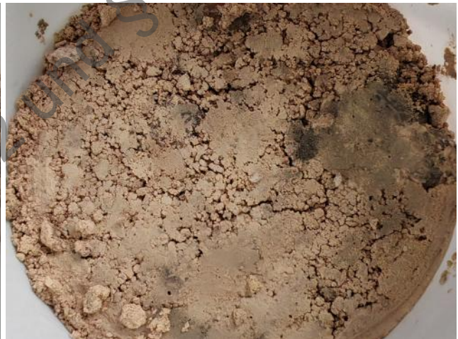
Foto 22: Homogenbereich 2.2 – Wiesenalkal, unbelastet (hier: Probe BS003-BP3.5)
