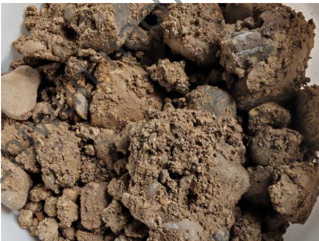
Foto 11: Homogenbereich 1.1 – kiesige Auffüllung, unbelastet (hier: Probe BS007-BP7.3)
