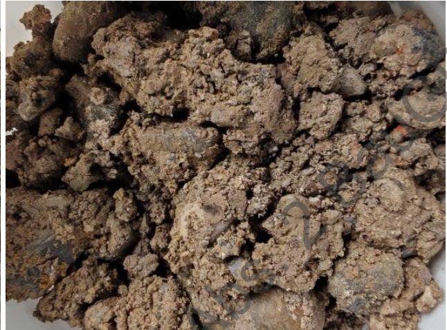
Foto 14: Homogenbereich 1.3 – kiesige Auffüllung, sehr hoch belastet, vereinzelt mit Fremdbeimengungen (hier: Probe BS006-BP6.2)
