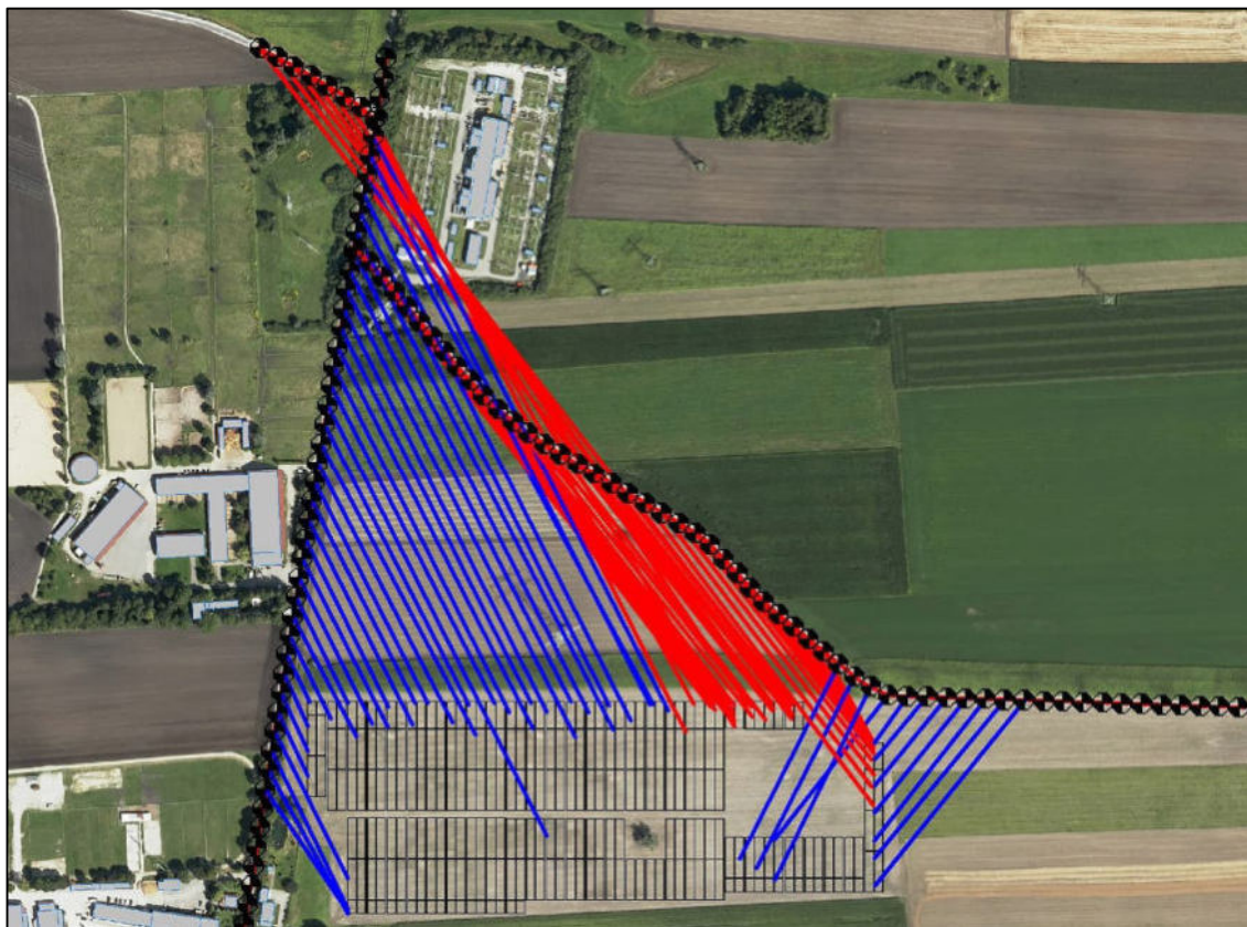
Abbildung 8: Luftbild mit Eintragung der von Blendungen betroffenen Immissionsorte mit Darstellung des jeweils ungünstigsten Reflexionsstrahls für beide Immissionshöhen /9/
