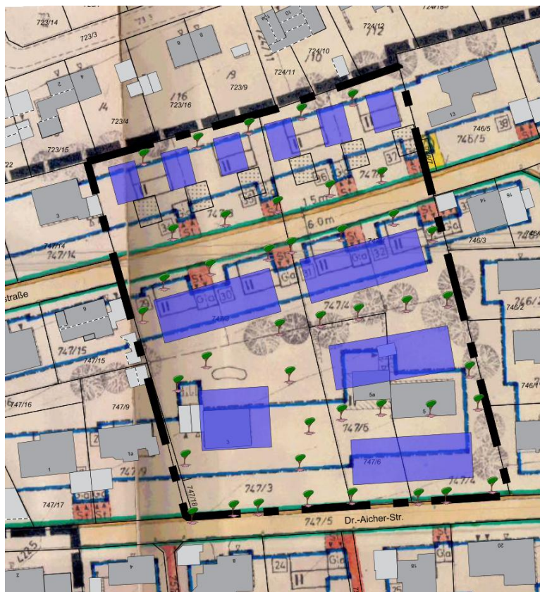
Überlagerung des Urplans mit der künftigen Rahmenplanung (geplante Gebäude in Blau) inkl. künftiger Baumstandorte (Baumzeichnung).
