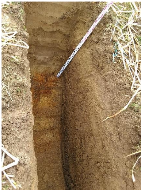
11 SCH 1 Oberkante sickertfähige Schicht
