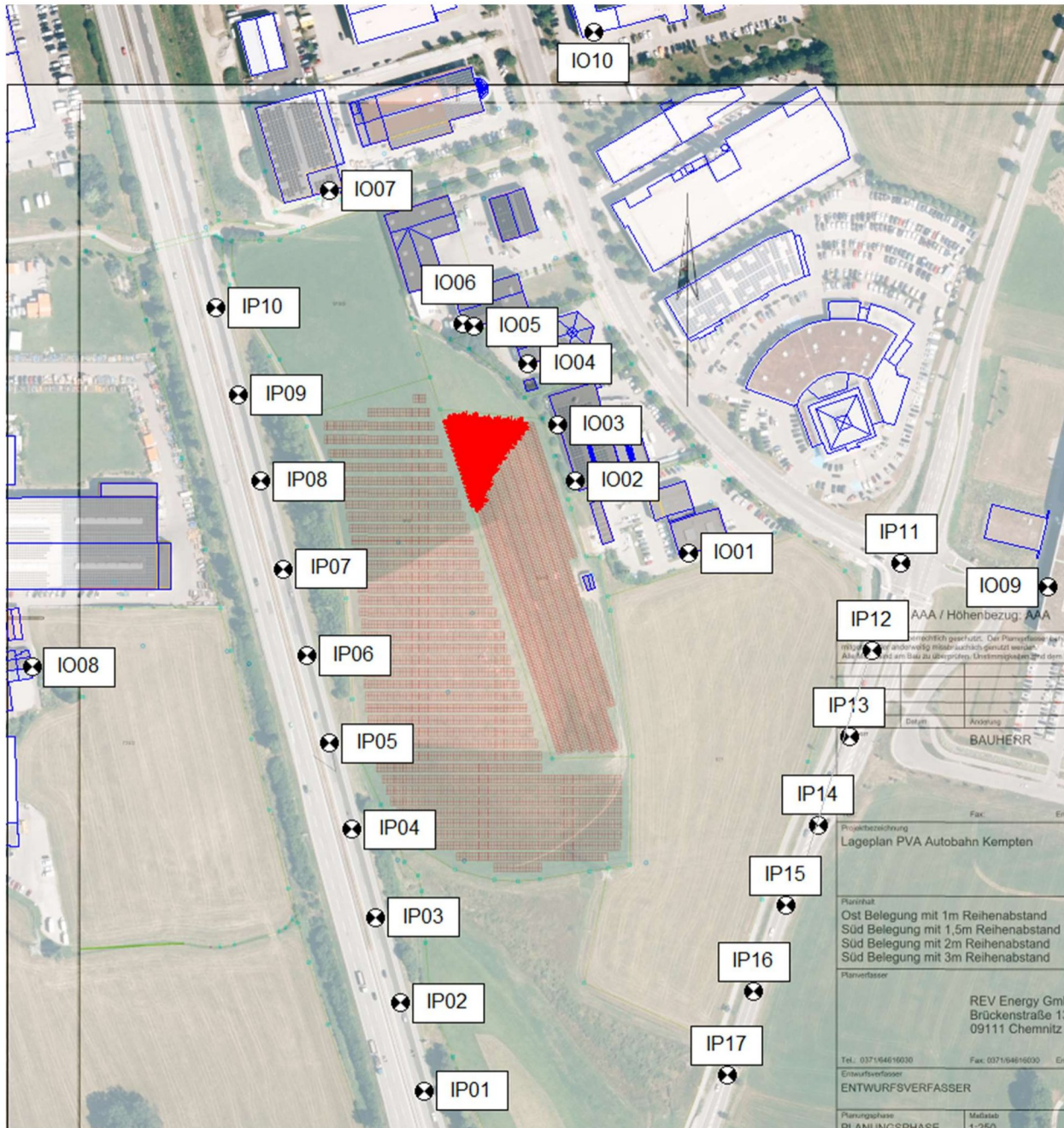
Abb. A17: Geplante Solaranlage mit Darstellung der Quellbereiche mit potentiellen Reflektionen am IO10
