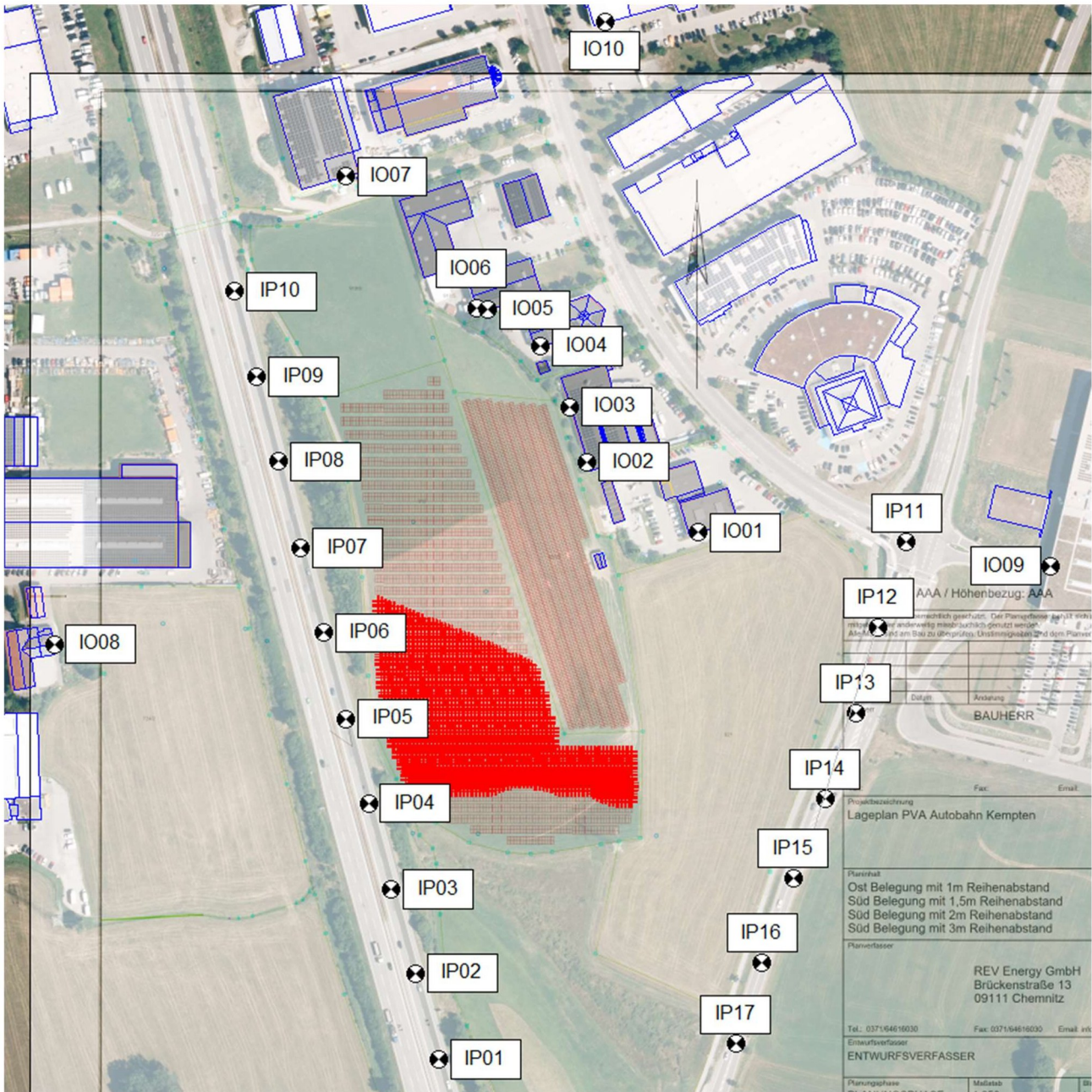
Abb. A10: Geplante Solaranlage mit Darstellung der Quellbereiche mit potentiellen Reflektionen am IP14
