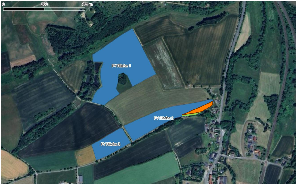
Abbildung 14: blendender Anlagenteil (orange) bezogen auf OP 7 und optionale Blendschutzmaßnahme (hellgrün) Blendschutzmaßnahme bei Wegfall des Gehölzes, Hintergrund: Google Earth Pro
