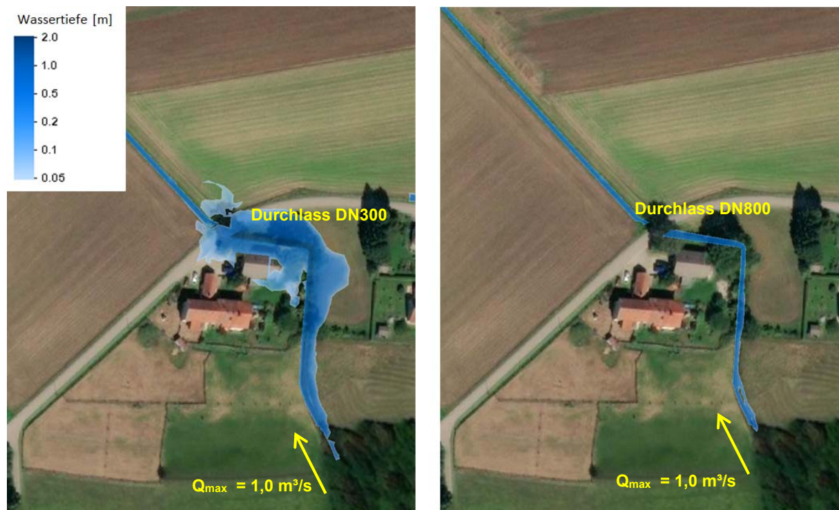
Abbildung 7.18: Vergleich DN300 und DN800 am Feldbach (HQ100+Klimazuschlag)
