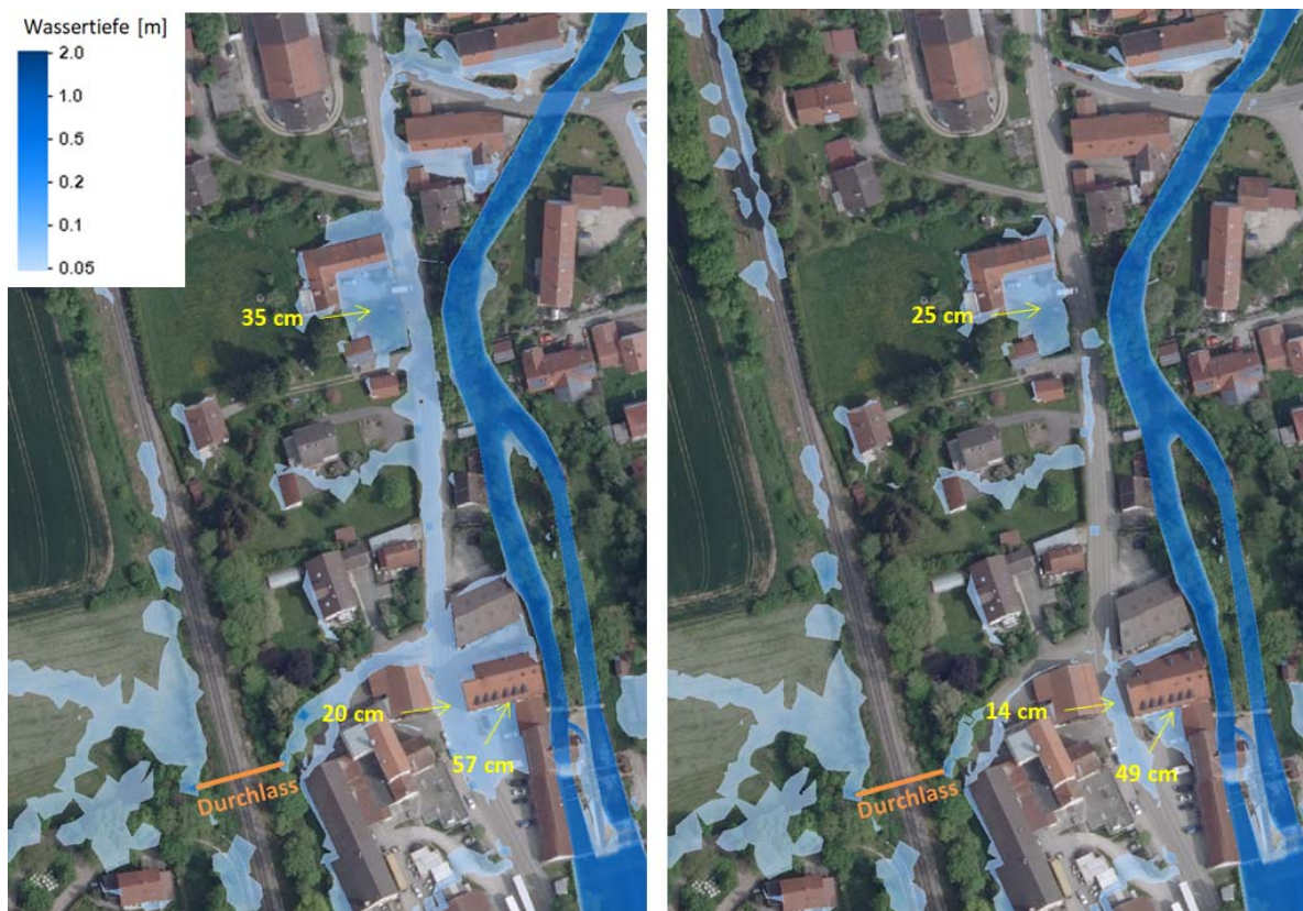
Abbildung 7.8: Wassertiefen Wifling Süd nach Anpassung der Leistungsfähigkeit des Kanals (N100)
