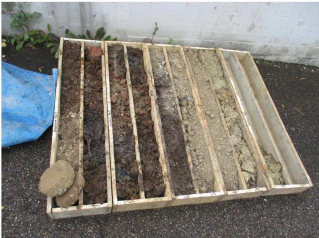
Abbildung 1: Kernkisten der Kernbohrung B 2, die dunkel gefärbten Auffüllungen der Altablagerung bilden einen gut erkennbaren Kontrast zu den umliegenden Böden
