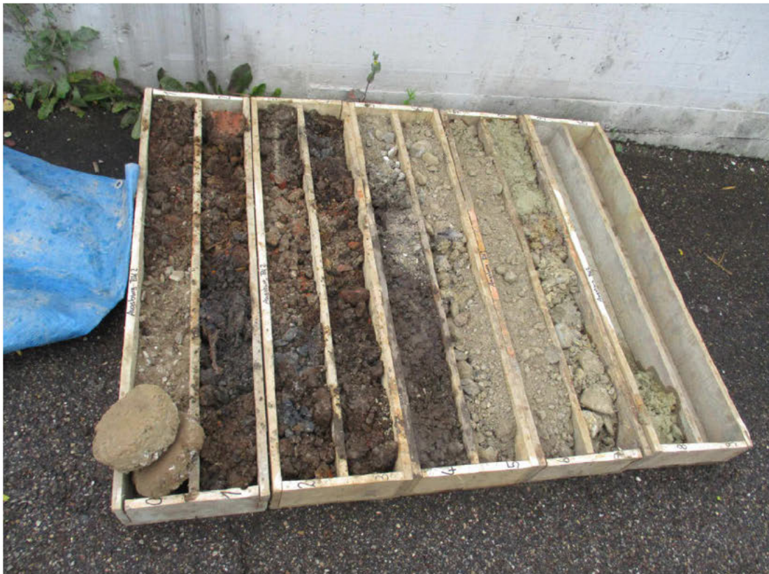
Foto 3: Schichtprofil Bohrung B2
