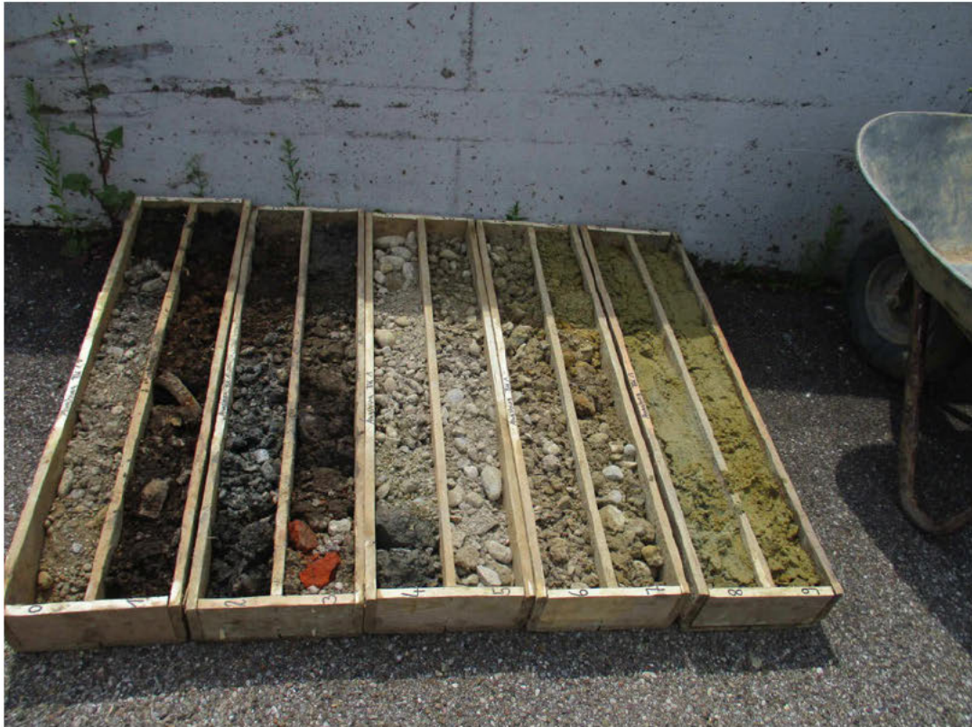
Foto 1: Schichtprofil Bohrung B1
